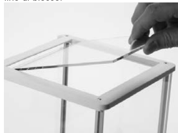
3) Installazione dello sportello superiore
