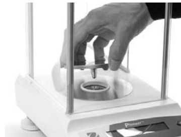
4) Installazione del vassoio
