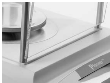
2) Vorder- und Rückplatten installieren - untere Kante in Rille einführen und drücken, bis sie einrastet.
