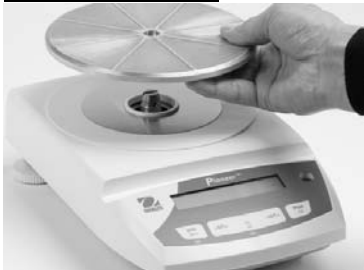
1) Installazione del supporto per il vassoio
